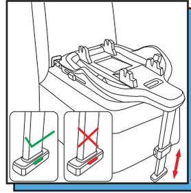
Upewnij się, że podpórka jest zablokowana w pozycji pionowej. Naciśnij przycisk regulacji: wyciągnij podpórkę, aż dotknie podłogi pojazdu. Wskaźnik podpórki na podpórce zmieni kolor na ZIELONY.
