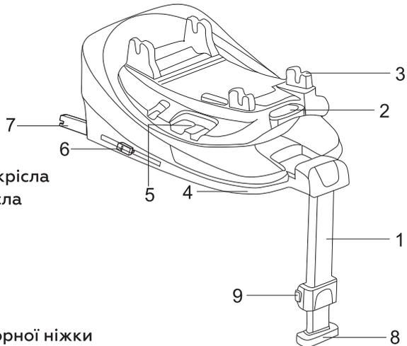
База обладнана поворотним механізмом для зручного встановлення автолюльки з поворотом до дверей. Кнопки обертання дублюються із двох сторін.
