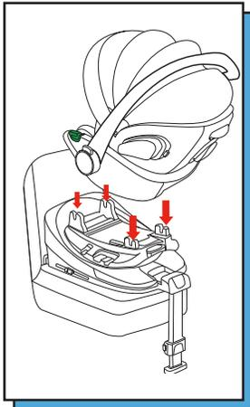
**WAŻNE:** Upewnij się, że na powierzchni bazy nie znajdują się żadne przedmioty i że dziecko jest zabezpieczone zintegrowanym systemem pasów, aby zapewnić prawidłowy montaż fotelika samochodowego w pojeździe.
