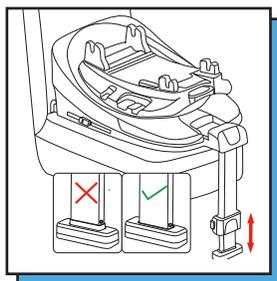
Upewnij się, że podpórka jest zablokowana w pozycji pionowej. Naciśnij przycisk regulacji: wyciągnij podpórkę, aż dotknie podłogi pojazdu. Wskaźnik podpórki na podpórcie zmieni kolor na ZIEŁONY.
