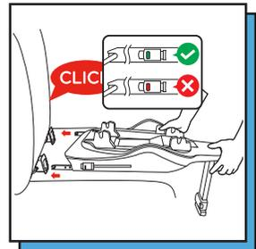
ISOFIX musi zatrzasnąć się w punktach mocowania ISOFIX ze słyszalnym kliknięciem. Sprawdź, czy podstawa jest dobrze zamocowana, próbując zdjąć ją z ISOFIX. ZIELONY wskaźnik bezpieczeństwa musi być wyraźnie widoczny na obu przyciskach ISOFIX.
