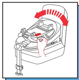
Aby obrócić podstawę, naciśnij przycisk obrotu, a następnie przekręć obrotowy dysk w odpowiednie położenie. Upewnij się, że podstawa jest zablokowana we właściwym położeniu. **WAŻNE** Nie używać podczas jazdy.
