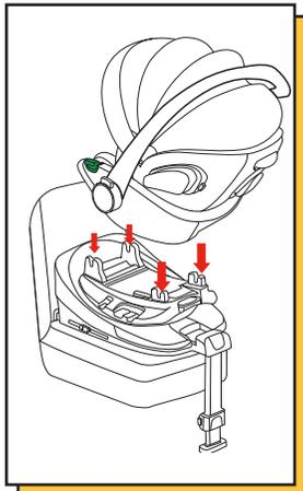
**ВАЖНО!** Убедитесь, что на поверхности базы нет никаких предметов, а ребенок закреплен встроенной системой ремней, чтобы гарантировать правильную установку автокресла в автомобиле.
