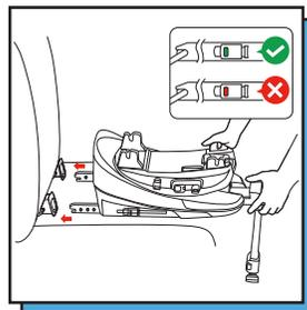
ISOFIX musi zatrzasnąć się w punktach mocowania ISOFIX ze słyszalnym kliknięciem. Sprawdź, czy podstawa jest dobrze zamocowana, próbując zdjąć ją z ISOFIX. ZIEŁONY wskaźnik bezpieczeństwa musi być wyraźnie widoczny na obu przyciskach ISOFIX.
