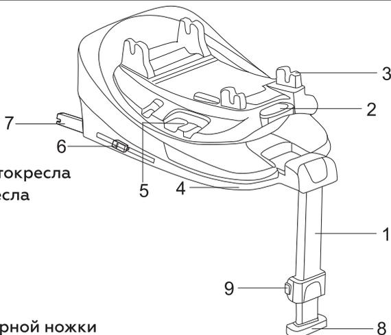
База оборудована поворотным механизмом для удобной установки автолюльки с поворотом к двери. Кнопки вращения дублируются с двух сторон.
