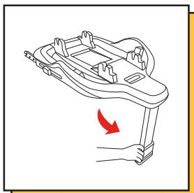
Извлекайте опорную стойку до тех пор, пока она не окажется в вертикальном положении.
