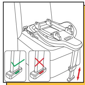
Убедитесь, что опорная стойка зафиксирована в вертикальном положении. Нажмите кнопку регулировки: извлекайте опорную стойку до тех пор, пока она не коснется пола автомобиля. Индикатор опорной стойки на опоре станет ЗЕЛЕНЫМ.
