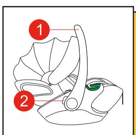
Чтобы отрегулировать ручку (1), одновременно нажмите левую и правую кнопки (2). Затем поверните ручку (1) вперед или назад, зажимая кнопки (2), пока она автоматически не зафиксируется в нужном положении.
