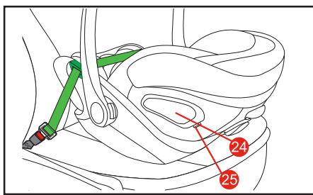
«Линейная защита от бокового удара» встроена в автокресло. Эта система повышает безопасность вашего ребенка в случае бокового столкновения. Для достижения наилучшего защитного эффекта активируйте защиту (24) в сторону двери автомобиля, ближайшей к автокреслу. Чтобы активировать, нажмите на отмеченную область (25). Если невозможно полностью высвободить защиту при закрытой двери автомобиля, вы также можете использовать детское автокресло с неактивной защитой.
