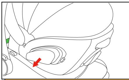
**ПРИМЕЧАНИЕ!** Убедитесь, что выдвижная часть зафиксировалась на месте со звуковым «ЩЕЛЧКОМ». Защиту можно полностью сложить в исходное положение, если выполнить действия в обратном порядке (сначала нажать 25, затем 24).
