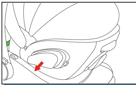
**UWAGA:** Upewnij się, że wysuwana część blokuje się na miejscu ze stycznym "kliknięciem".
