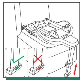
Переконайтесь, що опорна стійка зафікована у вертикальному положенні. Натисніть кнопку регулювання: витягайте опорну стійку доти, доки вона не торкнеться підлоги автомобіля. Індикатор опорної стійки на опорі стане зеленим.
