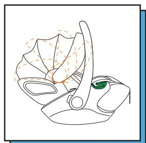
Rozłoż osłone, stopniowo pociągając za plastikową osłonę. Aby złożyć osłone, przywróć ją do pierwotnego położenia.
