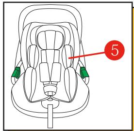
Вкладыш для новорожденного (5) можно снять, когда ребенок достигнет 61 см (около 3 месяцев), чтобы освободить ребенку больше места. Чтобы снять вкладку для новорожденного (5), откройте ремни и снимите наплечники. Затем снимите вкладыш для новорожденного и наденьте наплечники обратно на плечевые ремни.
